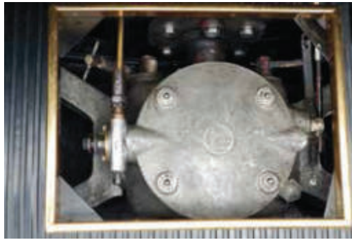
Schuricht Baujahr 1922. Links im Bild: Armaturenbrett mit Gangwähler. Links: Blick auf das Getriebe – links erkennt man den Anschluss der Spiralleitungen vom Gangwähler kommend.
