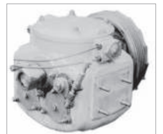
Oben und links: Soden- getriebe Serienstand ab 1921 mit optimierter Klauenverzahnung und in Getriebemitte platzierter Riegelwalze. Von außen ist der Stand am runden Getriebedeckel erkennbar (Quellen: ZF-Archiv).
