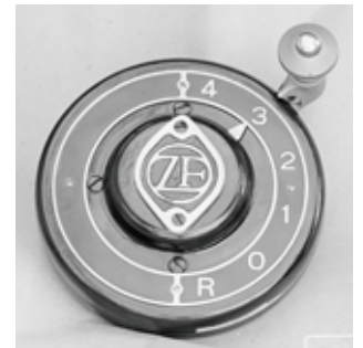
Gangwähler für die Lenkradnabe (Quelle: ZF-Archiv).
